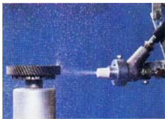
研磨剤を対象物に高速で吹き付けて隔壁を彫る
