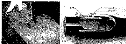
水道管の地震被害例 耐震管(継手)の例
