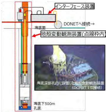
海底地殻変動観測システム概要図
