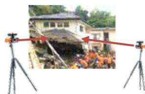
【建物崩壊・土砂監視センサー】
