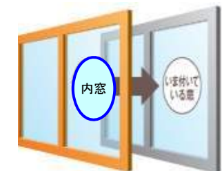
窓の 断熱改修工事
