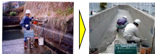
コア採取による強度測定
