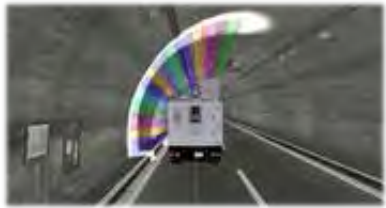
高速走行型非接触レーダーによるトンネル覆工の内部欠陥点検
