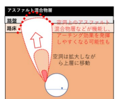
埋設管等の老朽化に伴う損傷が原因の場合 アスコン層厚化による抑制イメージ
