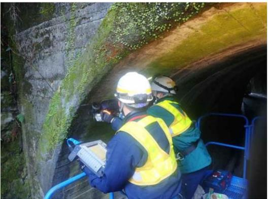
電磁波レーダー探査機を使用した作業状況
