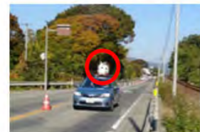
車載装置による路面性状測定
