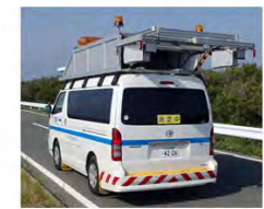
3次元レーザーセンサ を用いた舗装損傷検知
