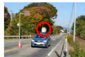
車載装置による路面性状測定
