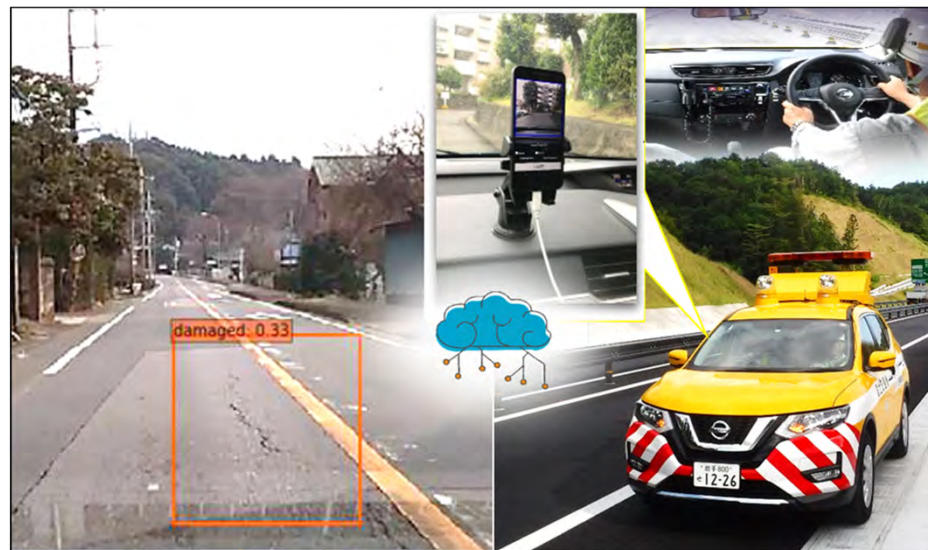
舗装損傷を自動検知
