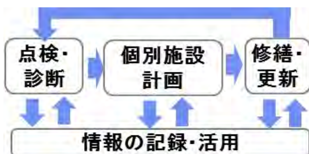
【個別施設計画に基づいたメンテナンスサイクルの構築】
