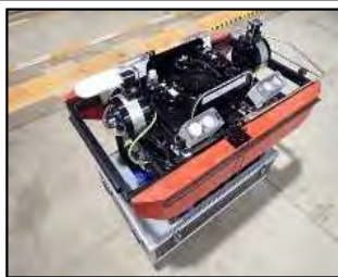
栈橋上部工下面の点検診断ロボット
