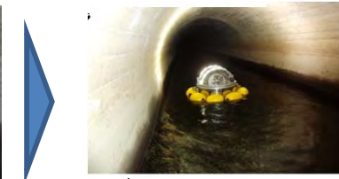
ロボットでトンネル内のひび割れ、漏水箇所を調査
