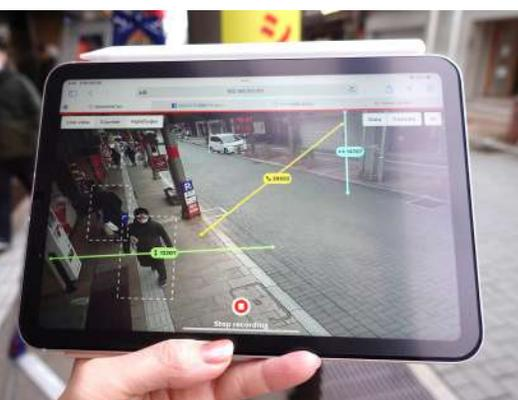
AIカメラによる計測画面 (映像は保存せず、計測結果のみ記録)
