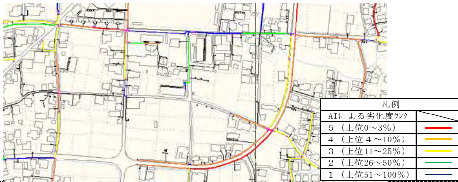
管路劣化診断結果を表示した水道マッピングシステムの画面
