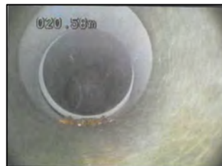
不断水管内カメラを活用した水道管内の調査を行う技術
