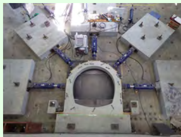
実物大試験体 載荷試験状況
