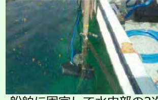
船舶に固定して水中部の3次元データを取得
