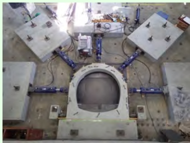
実物大試験体 載荷試験状況
