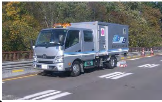
電磁波レーダー搭載車を活用して床版上面の調査を行う技術
