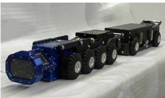
画像認識技術を活用して下水道管路の欠陥を自動検出する技術
