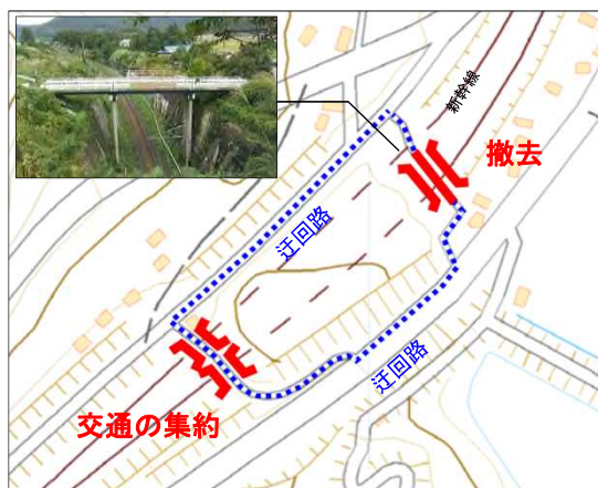
跨線橋を撤去し、隣接橋へ機能を集約
