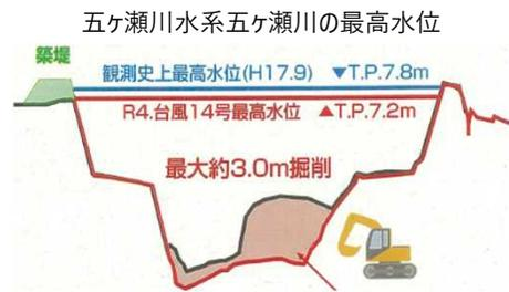
河道掘削等やダムでの事前放流により、氾濫をギリギリ回避し、浸水被害を大幅に軽減(被害は内水被害のみ)
