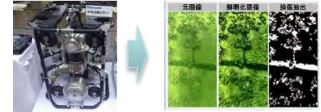
ロボットを活用して、ダム堤体等の画像データを取得し、AIで今後損傷抽出を効率化
