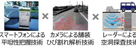
スマートフォンによる平坦性把握技術 × カメラによる舗装ひび割れ解析技術 × レーダーによる空洞探査技術
