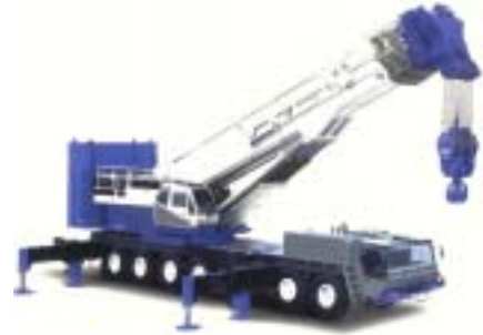
キャリアはドイツ製で、欧州では主力となっているオールテレーンクレーン
