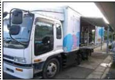
島しょ部では移動脱水車2台(公共・農集)の共同化により汚泥を減容化
